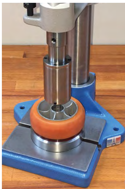
► 4HR con strumento di montaggio cuscinetti
