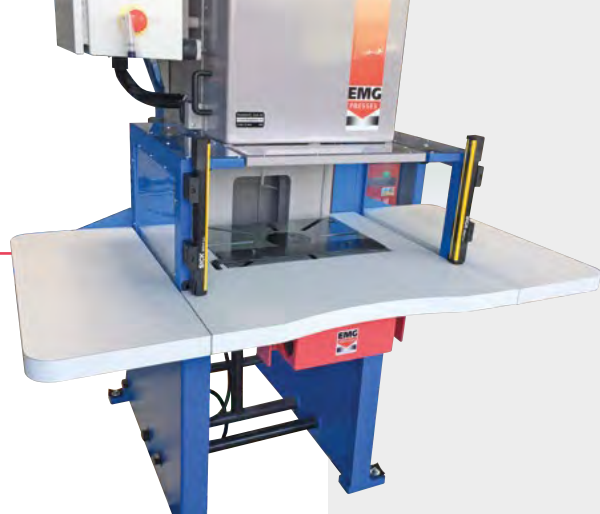
► 15T con integrazione di una piattaforma per il posizionamento di contenitori
