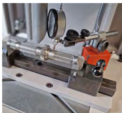
► 6TLP con strumento di raddrizzamento albero
