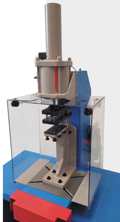
► 1T con strumento di crimpatura e area di lavoro speciale
